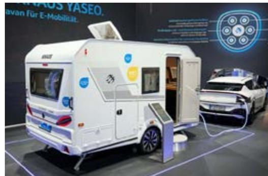
Este modelo va un poco más allá del funcionamiento totalmente eléctrico (sin instalación de gas), ya que han aligerado el peso y se ha reducido la superficie frontal para disminuir la resistencia al aire, y, en consecuencia, menos consumo y más autonomía. Además, lleva un sistema de alimentación que, aparte de la conexión a la red eléctrica, permite alimentarse de la propia batería del coche, si no se dispone de una toma a la red de 220 V.
