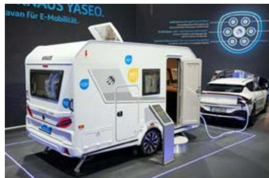
un vehículo eléctrico. Su funcionamiento es totalmente eléctrico (no lleva instalación de gas), que también supone aligerar el peso, y se ha reducido la superficie frontal para disminuir la resistencia al aire, y en consecuencia, menos
