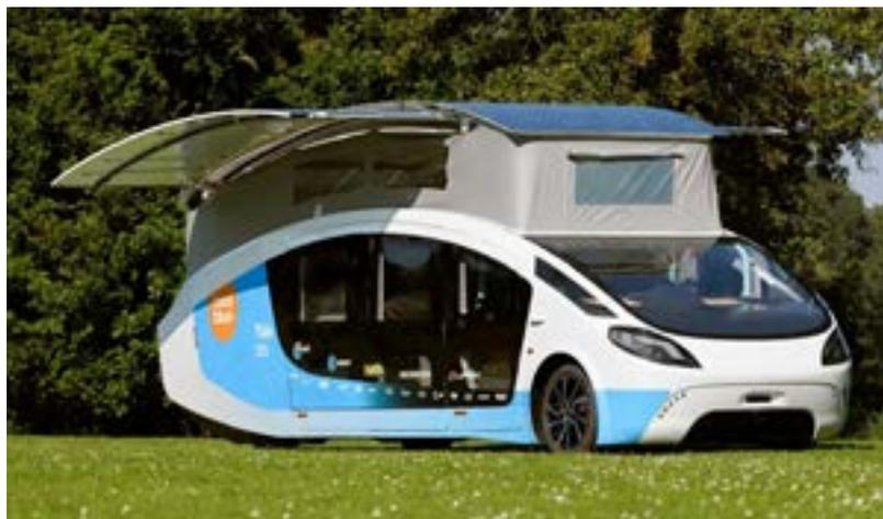
dos personas y sus dimensiones son 7,20 metros de largo, 2,05 metros de ancho y 1,83 metros de altura (4,40 metros de ancho y 2,54 metros de altura cuando despliega sus paneles solares, que ocupan una superficie de 17,5 metros cuadrados). Stella Vita ofrece una autonomía de, aproximadamente, 600 kilómetros, y alcanza una velocidad máxima de 120 km/h.
